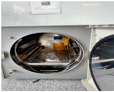
Figura.-3 Colocar medio de cultivo y materiales en el autoclave.
