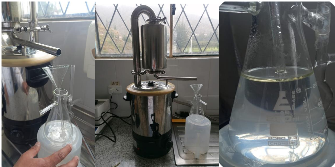
Imagen 4. Elaboración y extracción de aceites esenciales de ruda ( Ruta graveolens ) y eneldo ( Anethum graveolens ) en la maquina extractora de aceites esenciales en laboratorio, Campus Salache
