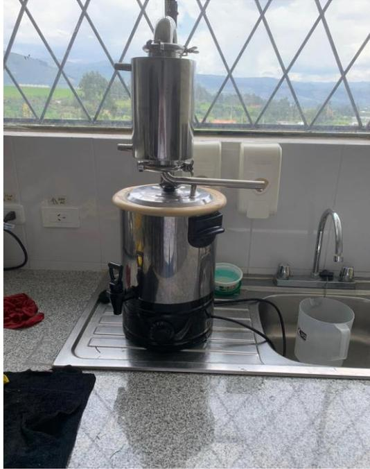
**Figura 7. Máquina de arrastre por vapor.**
