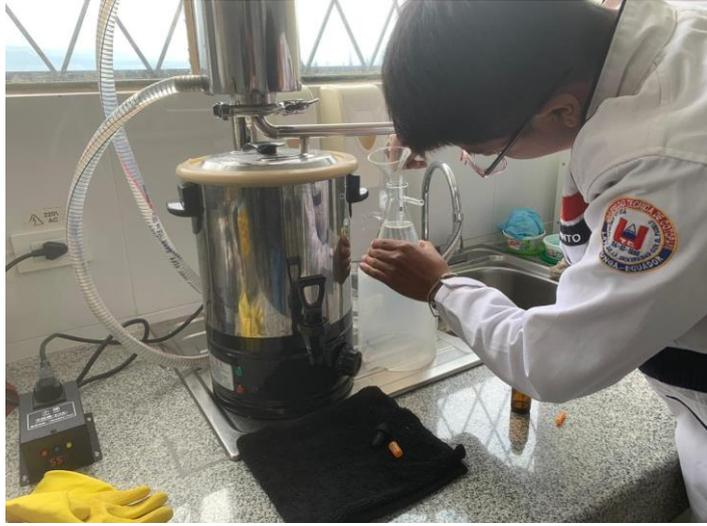
**Figura 9. Separación de la parte acuosa del aceite.**
