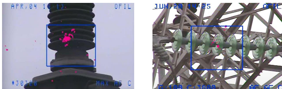
Figura 6: Aparición de efecto corona
