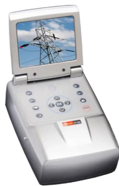
Figura 7: Equipo generador de UV para visualizar el efecto corona
