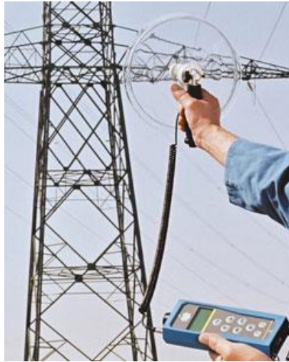
Figura 8: Ensayo de ultrasonido en una línea de transmisión
