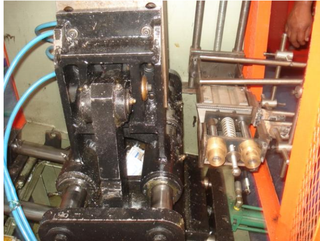
Figura 51: Comprobación de sus dimensiones del cortador de rebabas en la máquina.
