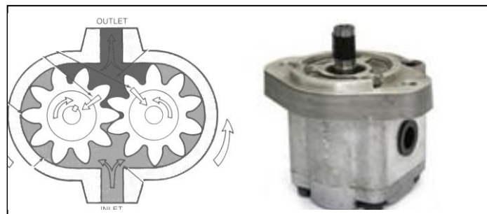
Figura 9: Bomba de engranajes externos
