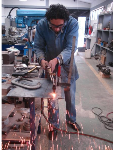
Figura 47: Corte de la plancha de hierro
