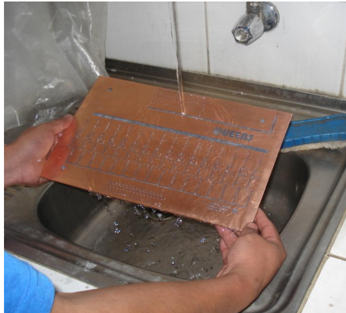
Figura 59: Retiro de papel termotransferible de la placa de cobre
