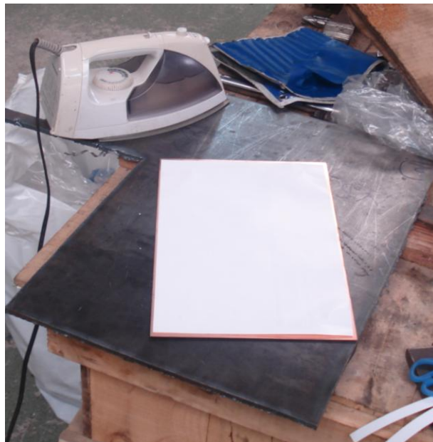
Figura 58: Placa de cobre lista para la transferencia del circuito
