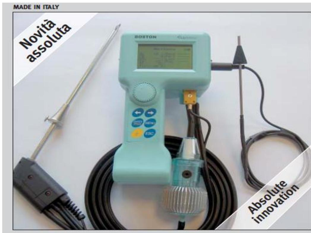
Figura 2.1: Fotografía del analizador de gas (BOSTON)
