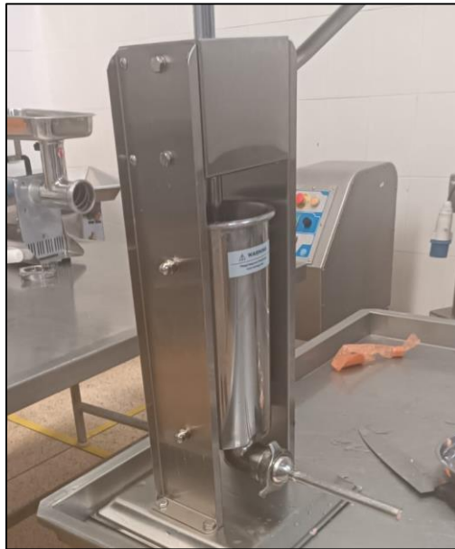
Figura 19 Embutir la mezcla en la tripa
