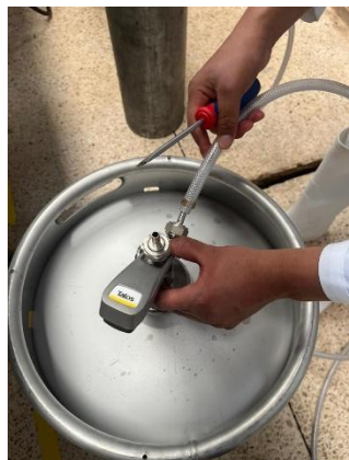
Imagen 1. Prueba de mangueras en las entradas y salidas de los tanques.
