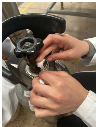
Imagen 2. Cierre de las entradas y salidas con teflón.
