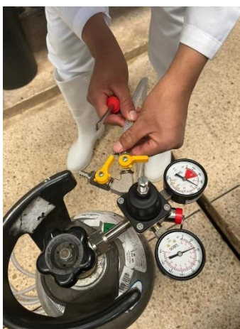
Imagen 4. Conexión de mangueras al tanque de dióxido de carbono.
