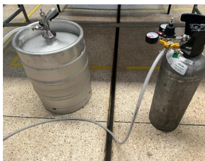
Imagen 5. Conexión del tanque de envasado con el tanque de dióxido de carbono.
