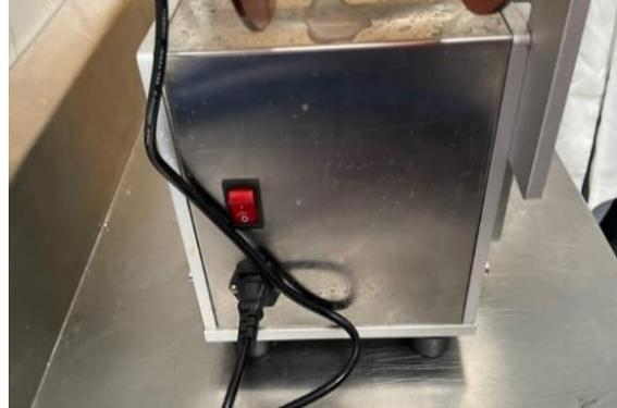
Interruptor de encendido y apagado
