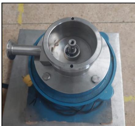
**Figura 14.** Instalación del rotor.
