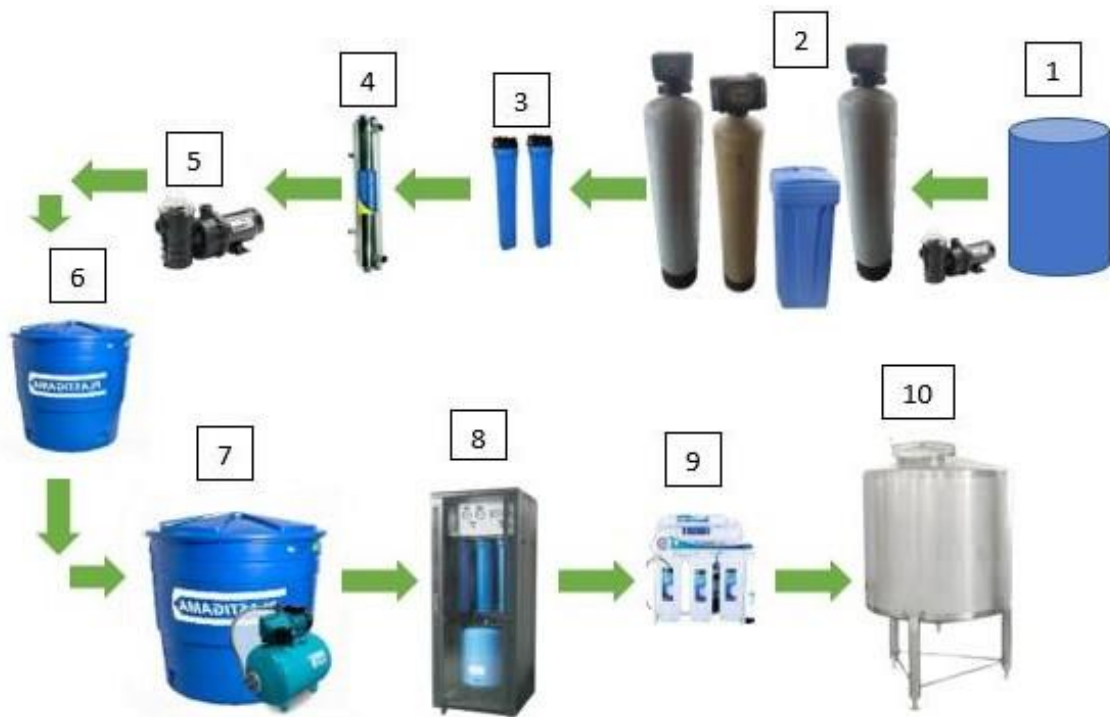
Figura 1. Diagrama de flujo de planta purificadora por ósmosis inversa de la de la Universidad Técnica de Cotopaxi
