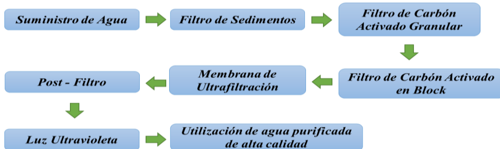
Figura 4. Etapas de un proceso de ÓI del equipo purificador King Kong RO 600-B12
