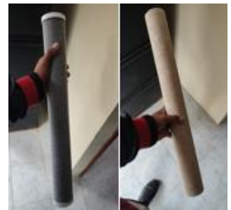
Filtros y membranas desgastados
