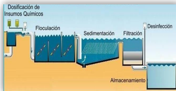
Ilustración 5. Procesos de tratamiento de agua
