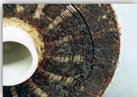
Ilustración 13. Membranas afectadas por Ataque bacteriano
