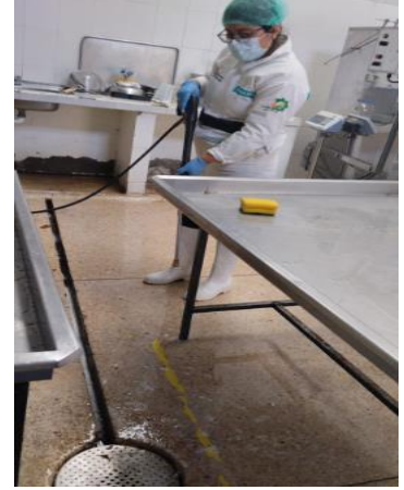
Ilustración 15. aplicación del espumante en pisos con el Espumador Doorway Sanitizer.
