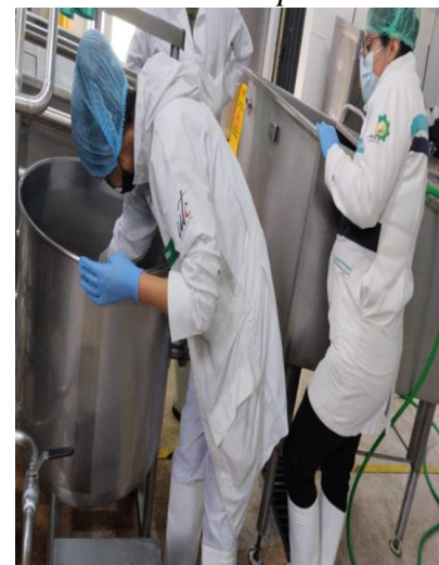
Ilustración 3. limpieza de la pasteurizadora de placas por afuera con esponjas y agua potable.
