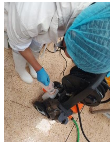
Ilustración 3. introducir el detergente en la hidrolavadora.
