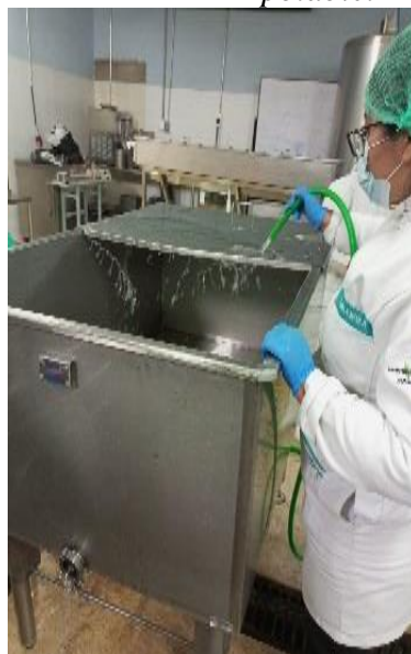
Ilustración 2. limpieza al tanque de la pasteurizadora con agua potable.
