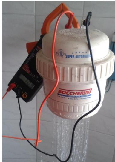
***Figura 13: Medición de voltaje***
