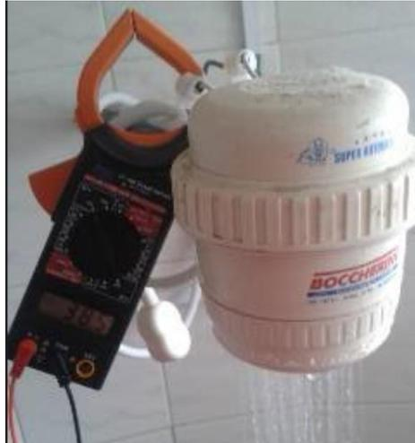
**Figura 14:** Medición de los amperios
