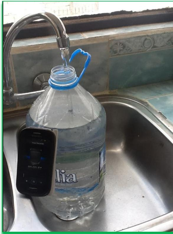
***Figura 12: Caudal de Agua en litros/min
