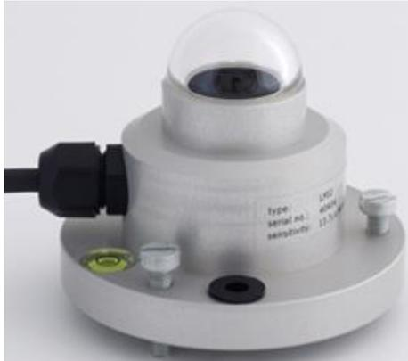
**Figura 3:** Piranómetro, medición de la radiación global, directa y difusa
