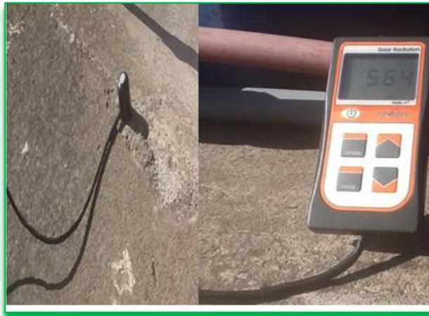
**Figura 11:** *Equipo piranómetro haciendo las mediciones de los datos*
