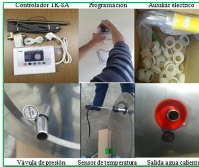
**Figura 21:** Controlador digital y sensores
