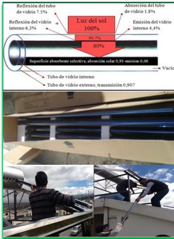
**Figura 19:** Características del tubo de vidrio al vacío
