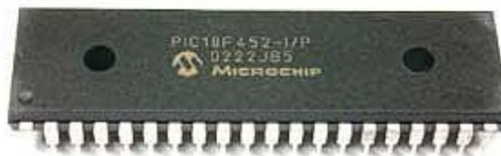
*Figura 3.12.- Microcontrolador PIC18F452*
