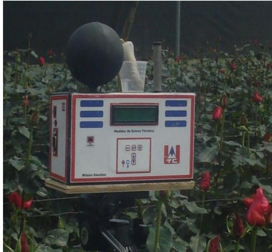
*Figura 4.20.- Medidor de Estrés Térmico*
