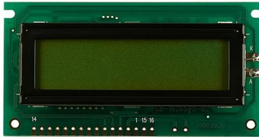
*Figura 3.16.- Pantalla de cristal líquido (LCD)*
