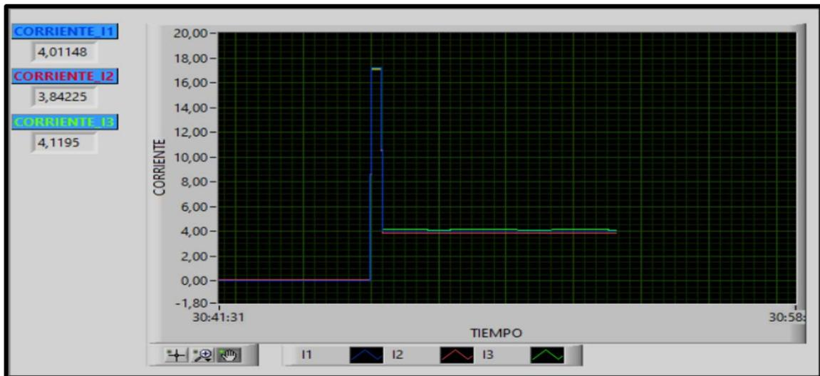
Figura I.2. Arranque directo con carga motor de 2 Hp
