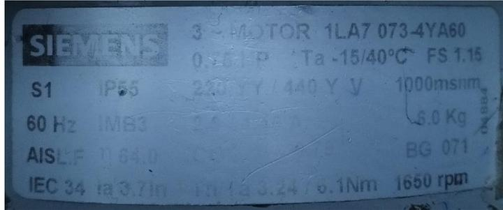
**Figura XVI.12.** Datos de placa de motor de 0,75 Hp
