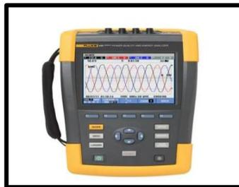
**Figura 3.17:** Analizador de redes Fluke 435-II [29]
