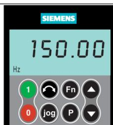
**Figura 3.1.** Panel BOP del variador de frecuencia.
