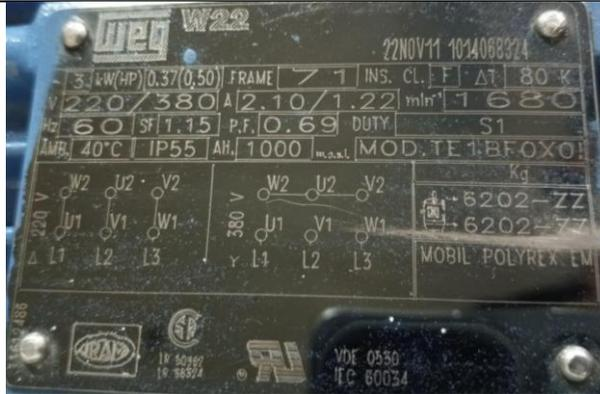
**Figura XVI.4.** Datos de placa de motor de 0,5 Hp
