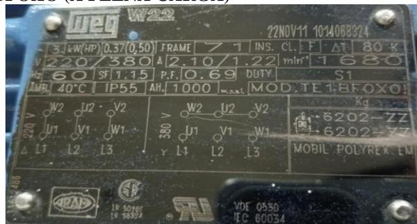
Figura XVI.14. Datos de placa de motor de 0,5 Hp
