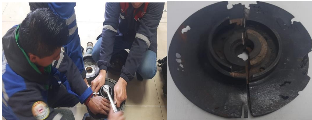
Figura 4.7. desmontaje del impulsor del eje.
