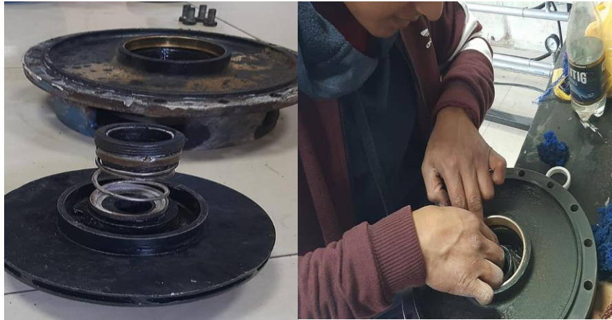
Figura 4.8. desmontaje del plato porta estacionarios y sello mecánico.
