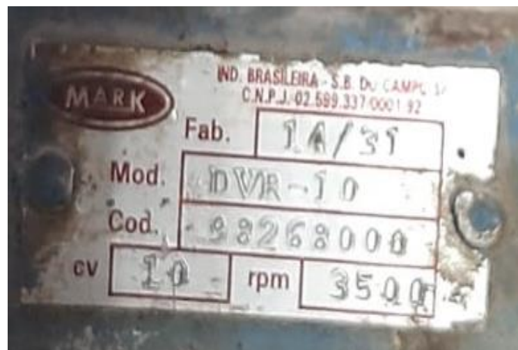
Figura 2. Placa de datos de la bomba.
