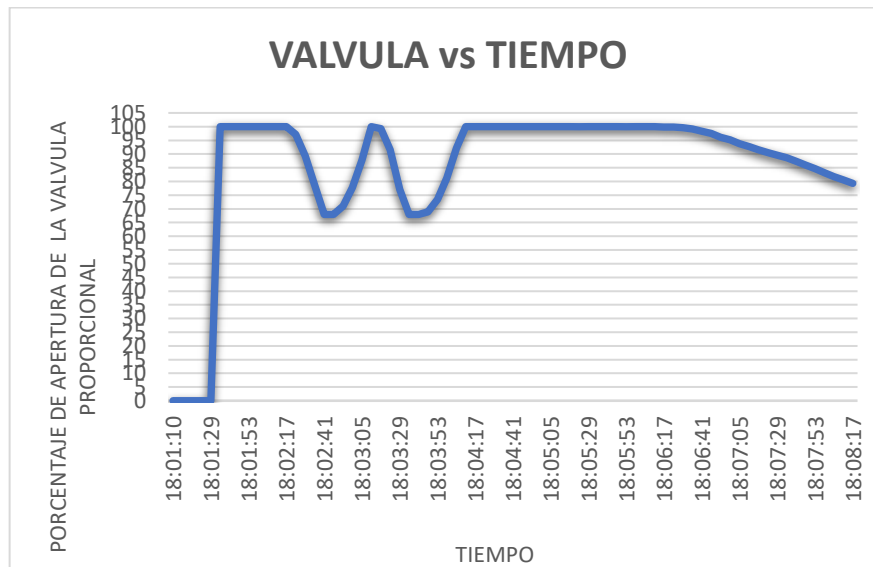
Figura 4.4 Apertura de la válvula proporcional a 65 °C
