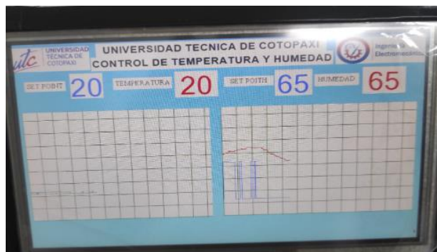
Figura 16: ingreso de variables de temperatura y humedad
