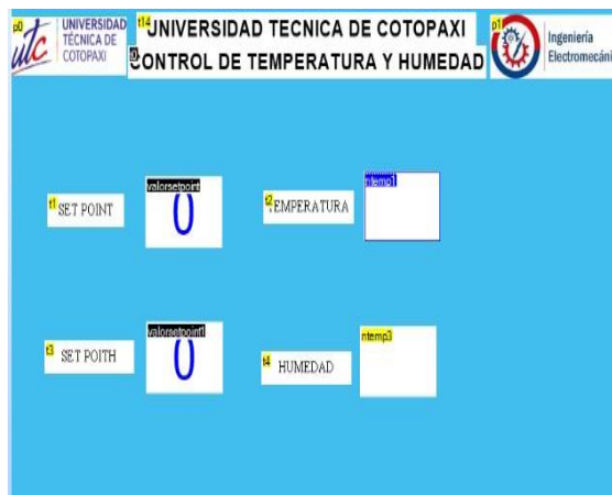
Figura 12: entorno programado de la pantalla nextion
