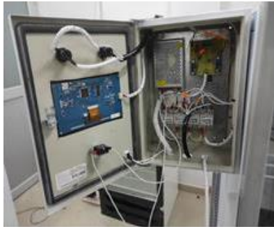
Figura N°23 Interfaz conexión máquina
