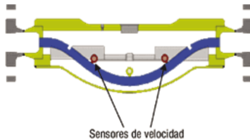
Figura 2.11: Medición del efecto Coriolis. [15]
