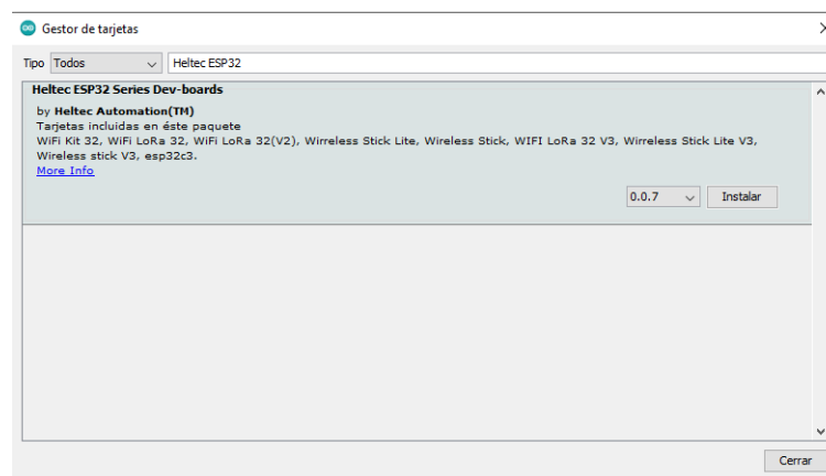
Figura 3.6: Instalación de la librería Wifi LoRa 32 (Paso 4).
