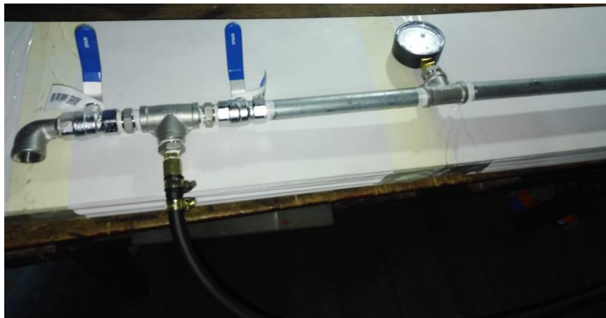
Figura 3.27 Sistema de tubería de aire comprimido
