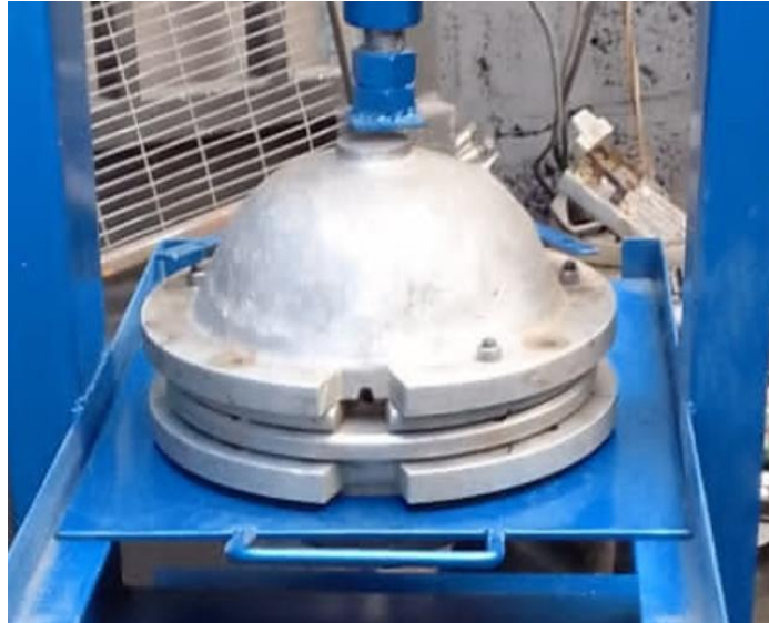
Figura 3.35: Apriete correcto de las dos tapas del molde
