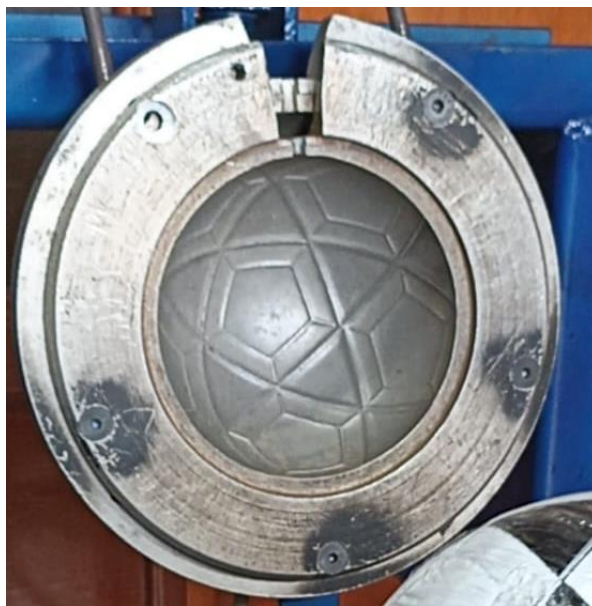
Figura 3.34: Venas internas en el molde
