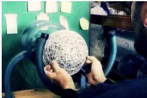
Figura 2.8: Bobinado del balón de fútbol [7]
