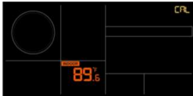
Ilustración 1. Ajuste de calibración del equipo. Fuente; Manual de la estación meteorológica.
