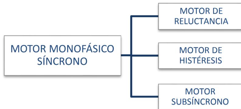
Figura 3.16 Clasificación de motores monofásico síncrono [20].
