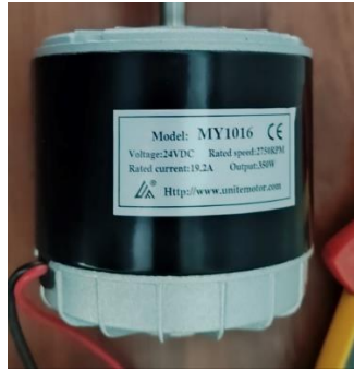
Fig. 46 Datos de placa del motor DC.
