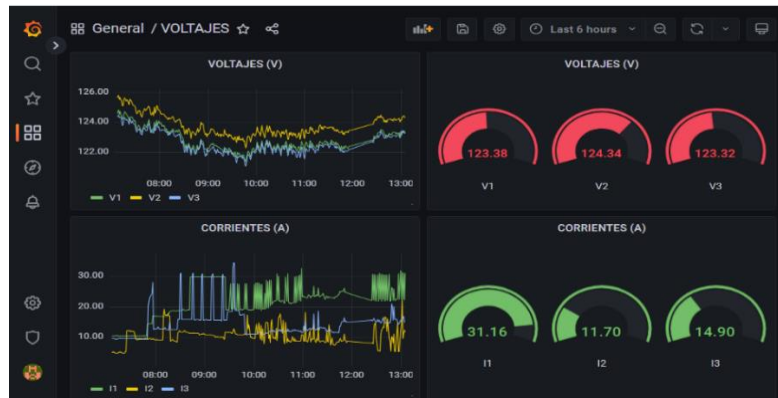
Figura 4.5. Panel visual del sistema de monitoreo del consumo energético y parámetros eléctricos medidos
