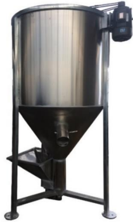
Figura 5: Máquina mezcladora vertical con tolva al piso
