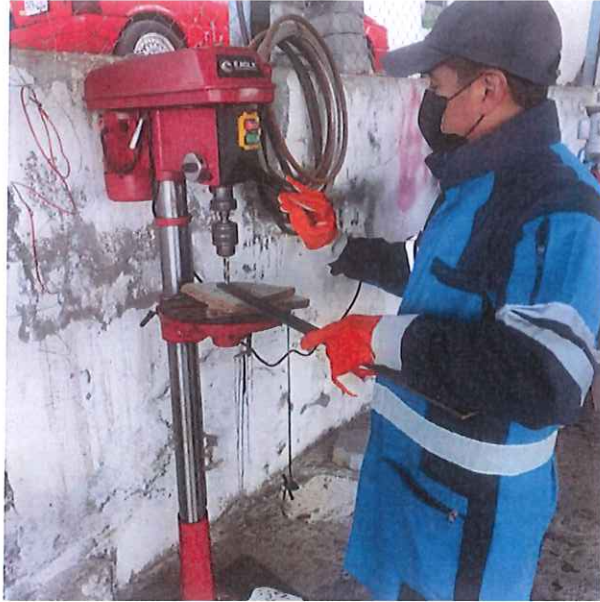
Figura III. Perforación de una pieza en el taladro de banco.
