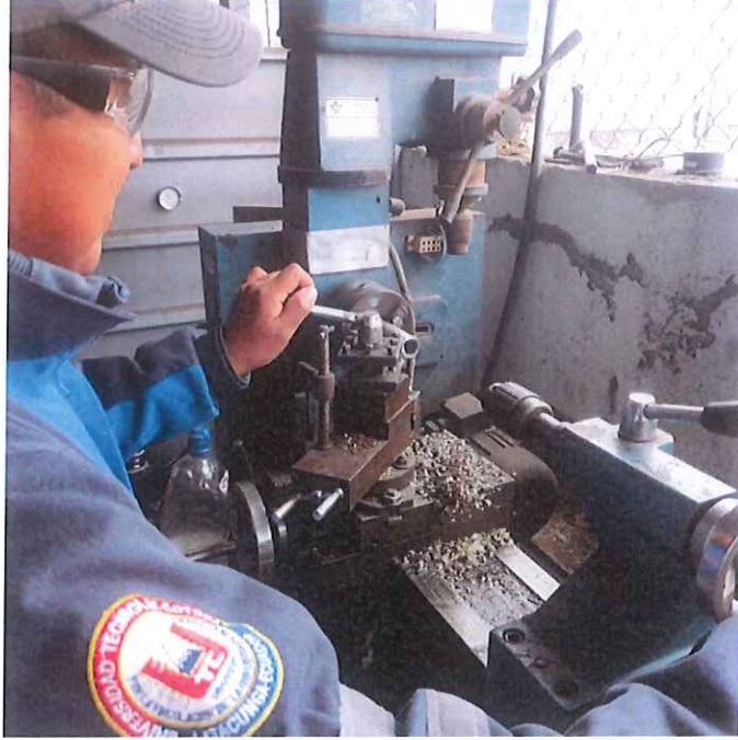
Figura I. Proceso de torneado de un eje para las ruedas de la silla.
