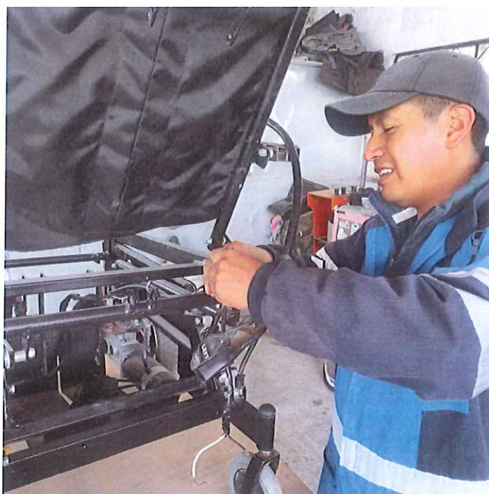
Figura VIII. Ensamblaje del espaldar de la silla.
