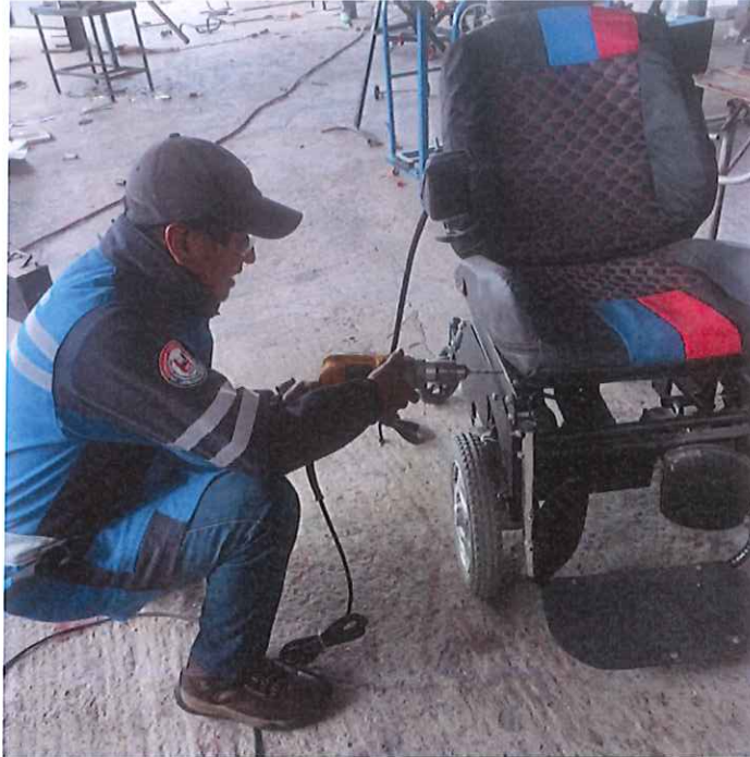
Figura V. Colocación de las tapas de la silla bipeDESTADORA.
