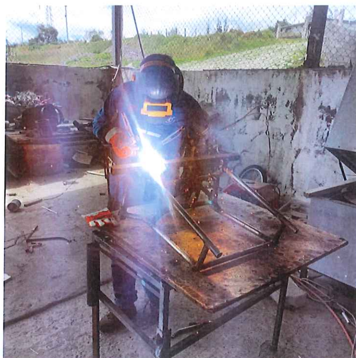
Figura XV. Proceso de soldadura de la estructura.
