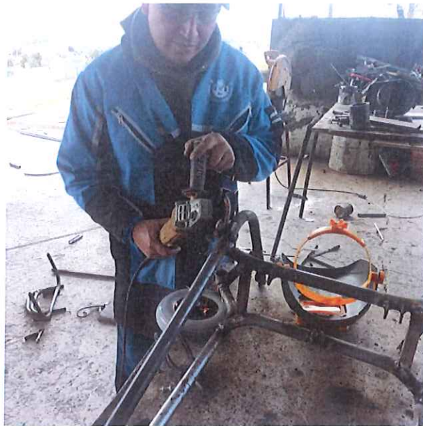
Figura VI. Proceso de pulido de la estructura de la silla bipedestadora.
