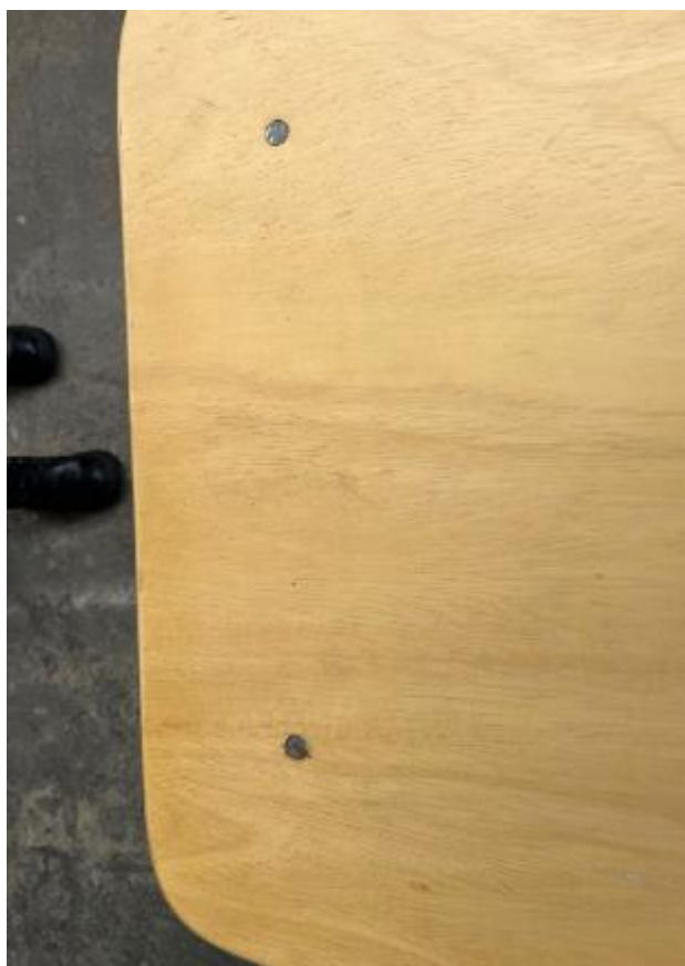
Anexo 6.5: Resistencia de la silla al impacto repetido
