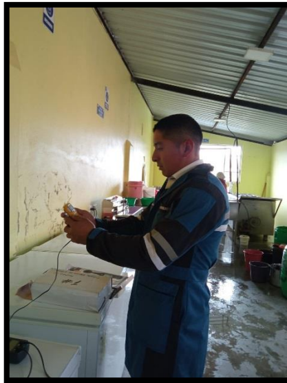
Figura 3.35: Medición N° 2 de iluminación: 109 Lux
