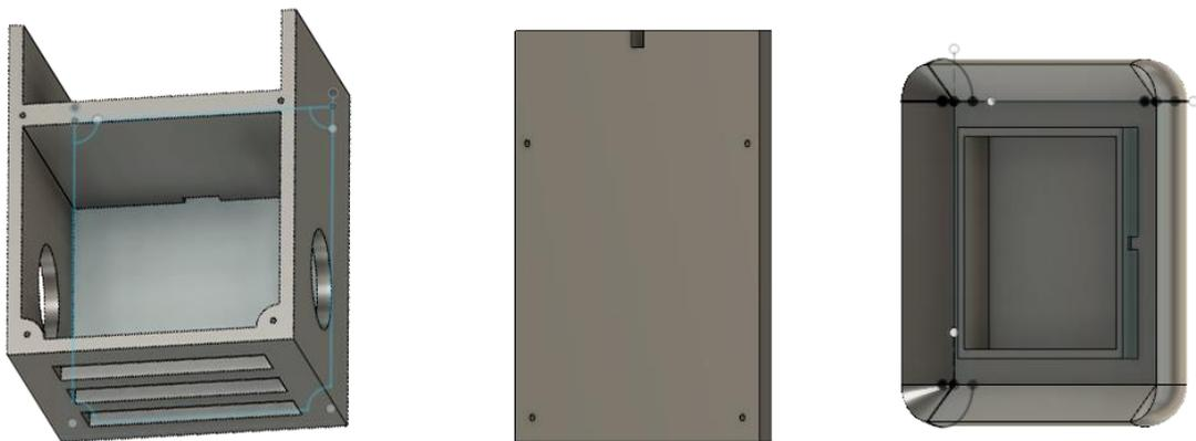
Figura 3.22: Carcasa de protección del medidor de agua inteligente
