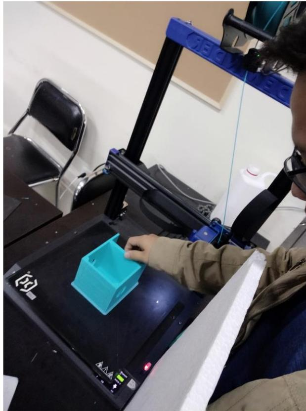
Figura X. 1: Impresión 3D de la base del medidor inteligente
