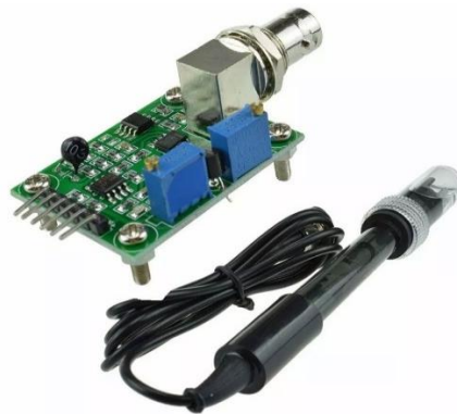
Figura 3.8. Sensor de pH de agua [10].
