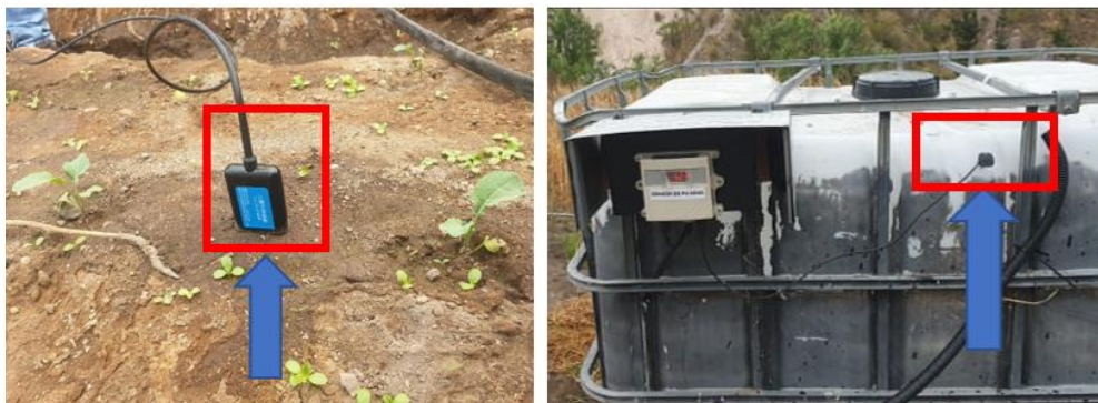
Figura 9. Conexión de sensores ph (Suelo, Agua).
