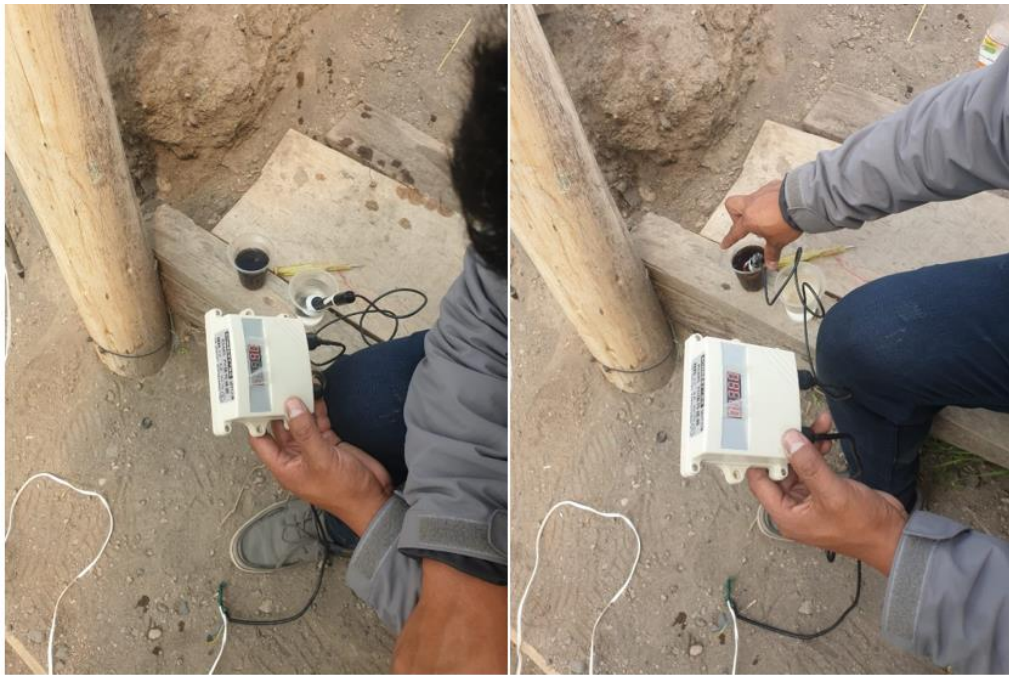
Figura M.3. Prueba con Patrones (Coca-cola) (Agua Destilada).
