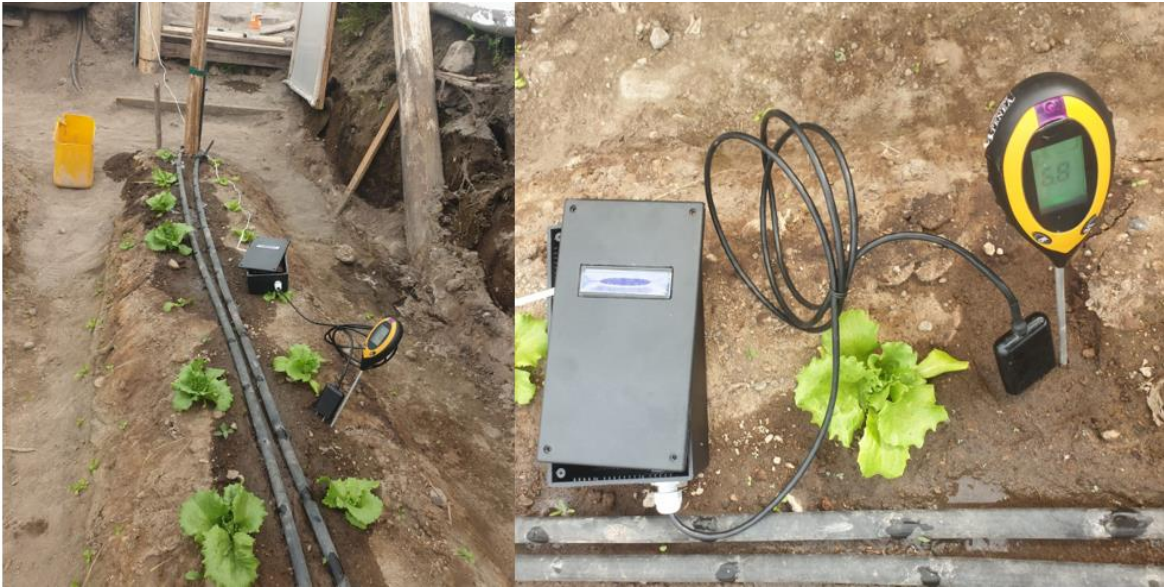
Figura M.4. Pruebas comparativas de medidor de ph suelo modelo ( phsoil 401).
