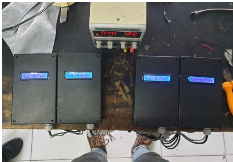
Figura 4.6. Módulos para enviar y recibir los datos del sensor.
