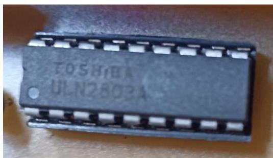
Figura 4. Circuito integrado ULN2803A de la Marca Toshiba.
