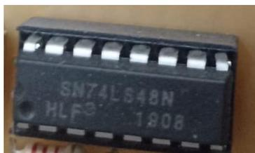
Figura 5. Circuito Integrado 74LS48.
