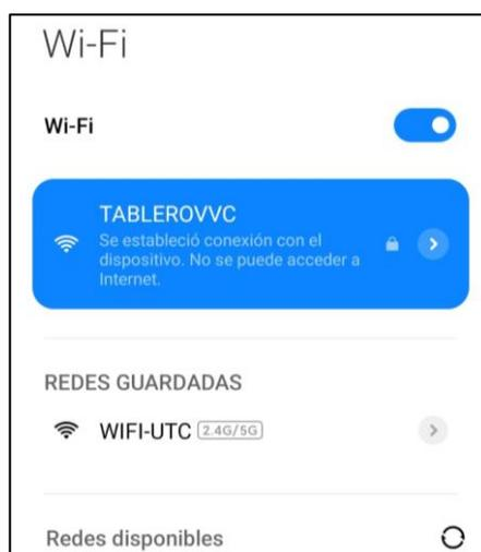
Figura 29. Conexión a Wi-Fi para el módulo ESP8266.
