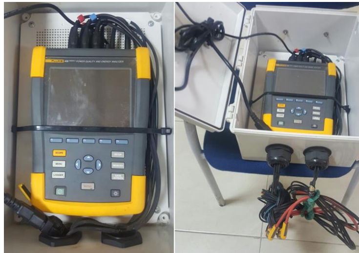
Ilustración 3.2 Analizador de calidad de energía trifásico FLUKE-435 SERIES II
