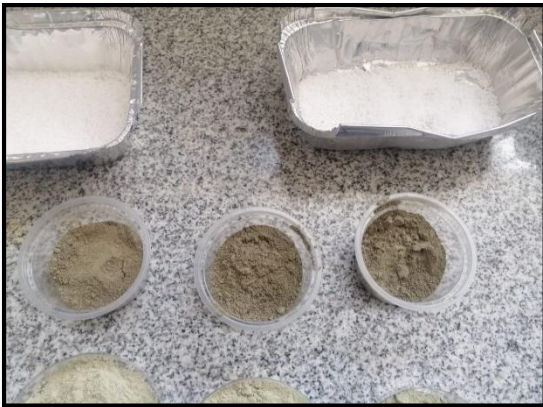
Fotografía 3. Recubrimiento de urea con roca fosfórica más estiércol de vaca con polímero de almidón de papa.
