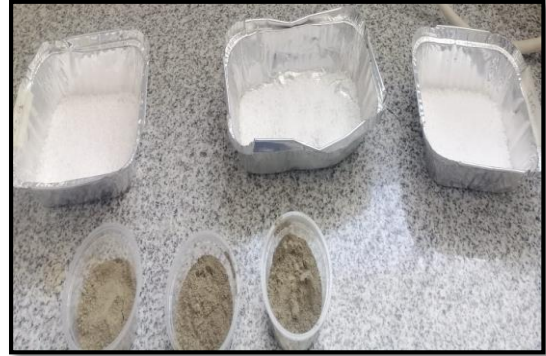
Fotografía 2. Recubrimiento de urea con zeolita más humus con polímero de almidón de papa.
