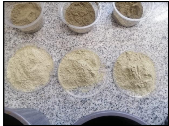
Fotografía 4. Recubrimiento de urea con roca fosfórica más humus con polímero de almidón de papa.
