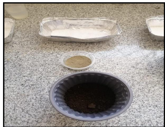
Fotografía 6. Recubrimiento de urea con zeolita más humus con polímero de ethocel.
