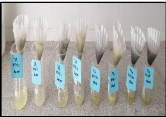
Fotografía 11. Se observó durante 24 horas en un vaso de 500 ml, que se mantuvo los 100 ml de agua destilada que se incorporó a los materiales inertes y orgánicos usados para el recubrimiento.
