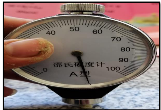
Fotografía 22. Medición de la dureza del recubrimiento con el durómetro, se observó que el tratamiento T6R1 y sus repeticiones tienen resultados mayores que los demás tratamientos.
