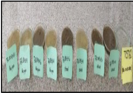
Fotografía 13. Determinación de la capacidad de absorción de las ureas recubiertas y sin recubrir.
