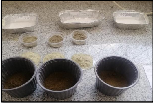
Fotografía 1. Inicialización del primer protocolo con las cantidades indicadas para el recubrimiento de la urea con zeolita más estiércol de vaca con polímero de almidón de papa.
