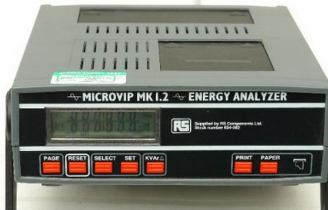
FIGURA 1.10 ANALIZADOR DE ENERGIA
