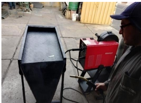
Fig. 29. Proceso de soldadura de la estructura del colector
