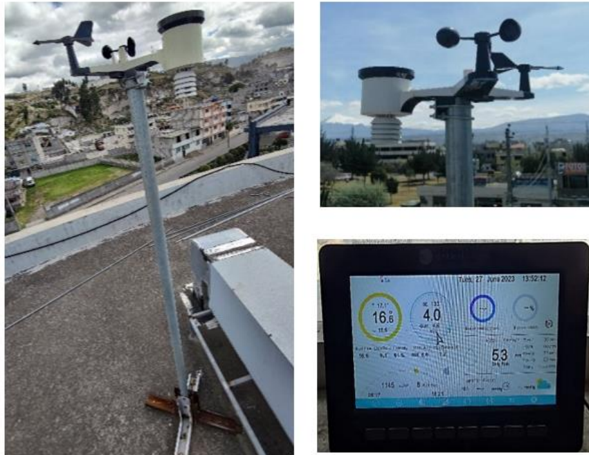
Fig. 22. Estación meteorológica recolectando datos del clima; módulo para toma de datos de la estación meteorológica
