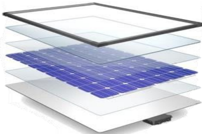
Fig. 7. Cubierta de vidrio usada para un colector solar [23]
