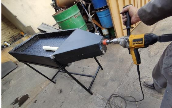
Fig. 27. Perforación de entradas y salidas del flujo de aire del colector
