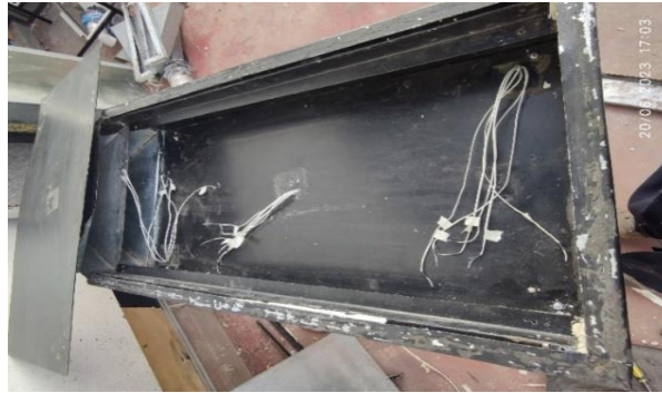
Fig. 30. Identificación de termistores del colector. Colocación de placas planas.
