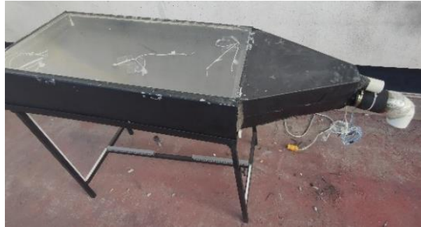
Fig. 33. Sellado del vidrio del colector con silicón industrial
