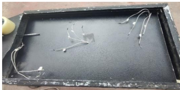
Fig. 32. Fijación de termistores en la estructura del colector.
