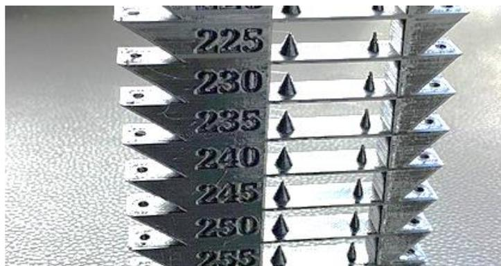
**Figura 28** Torre de temperatura ABS
