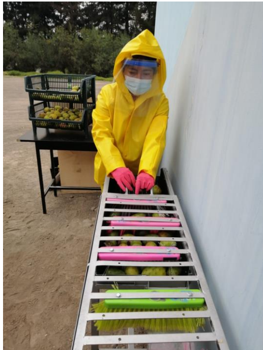
Fotografía 3. E1: Limpieza mecánica con escobas.
