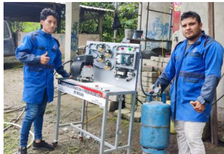
Imagen 24. Llenado de cilindro de biogás por medio del equipo de extracción y presurización de la UTC
