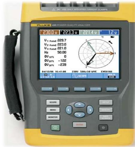
**Figura 5** Analizador de Redes Fluke
