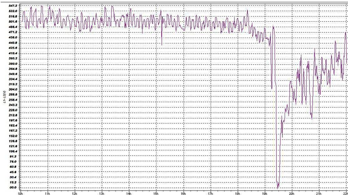
**Figura 36** Variación De Voltaje L1 – L3 (Tablero De La Planta Uht)
