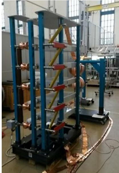
Fig. 39. Pruebas de voltaje de impulso sin objeto bajo prueba
