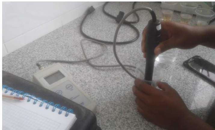
Prueba de conductividad para trigo y cebada
