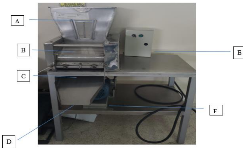
Figura 8 Componentes externos de la laminadora de alimentos en procesos de transformación agroindustrial
