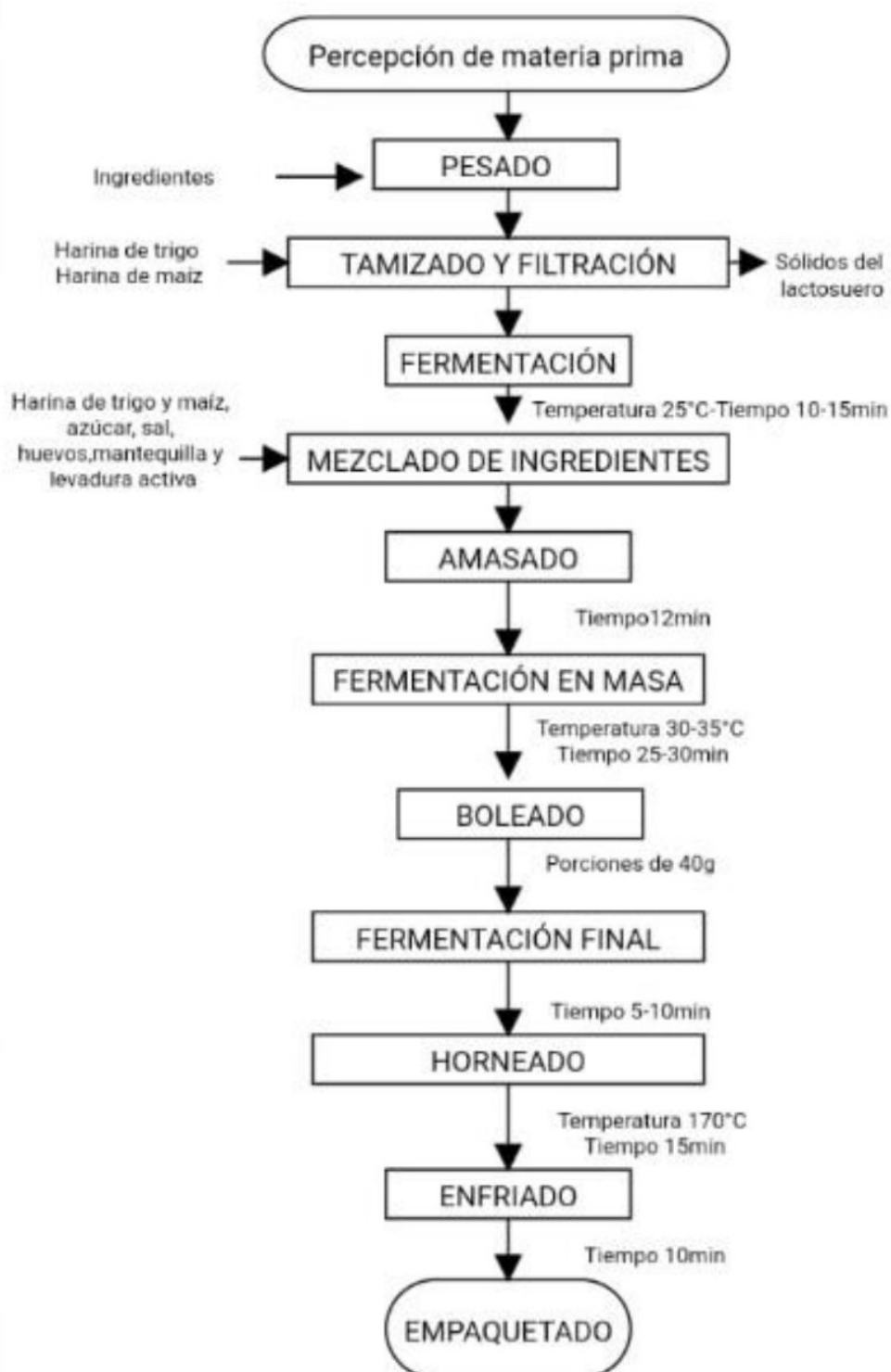
Gráfico 2. Diagrama de flujo del proceso del pan
