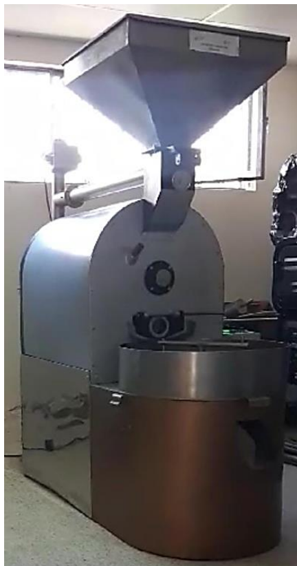
Figura 8. Tostadora de granos con enfriador
