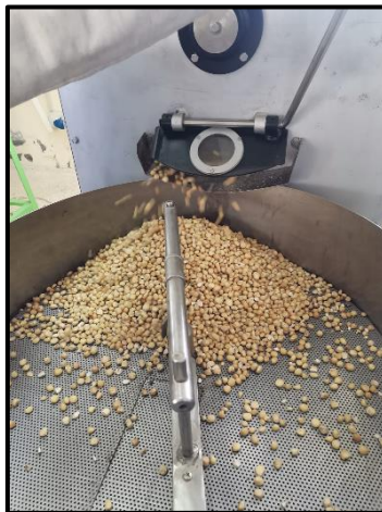
Figura 37. Deposito del grano en el enfriador.
