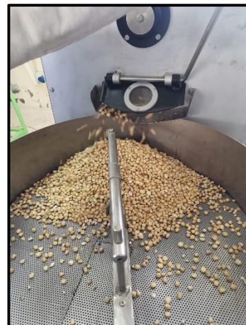
Figura 52. Proceso de enfriamiento.
