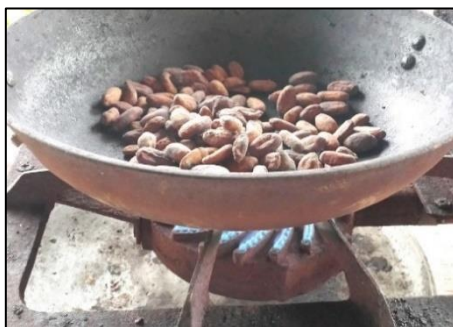
Figura 4. Tostadora de llama directa.
