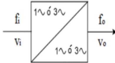
**Figura 2.3:** Diagrama de bloques de un cicloconvertidor.
