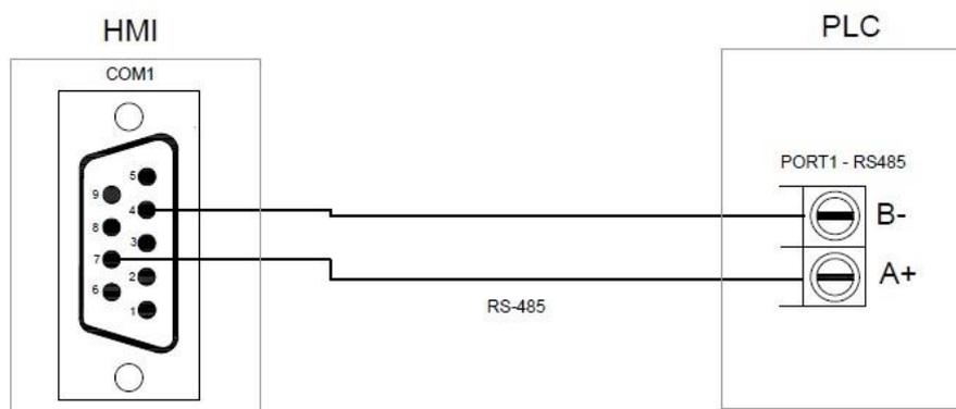
Figura 3. 6. Comunicación de PLC y el HMI por el RS485
