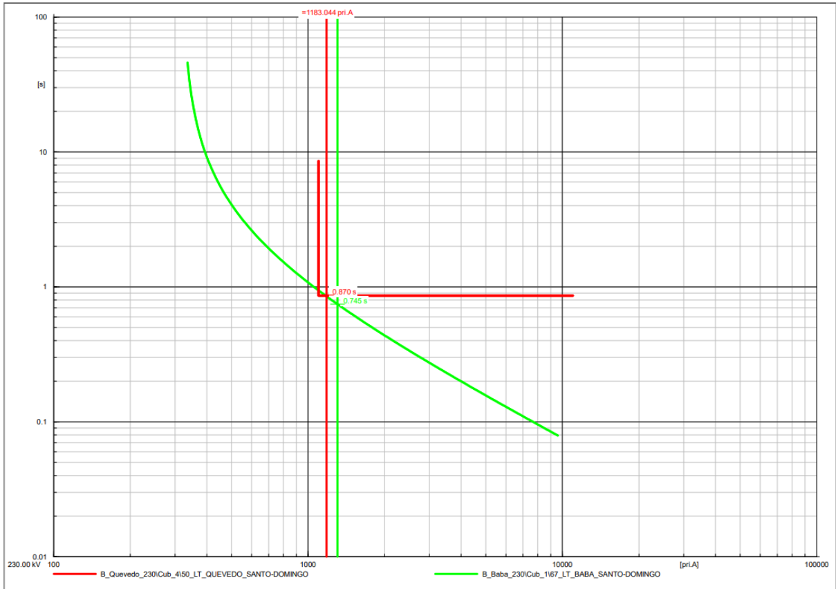
Figura 5.4 Coordinación Quevedo-Santo Domingo-Baba relé 67 direccional temporizado e instantáneo 50 en sentido antihorario
