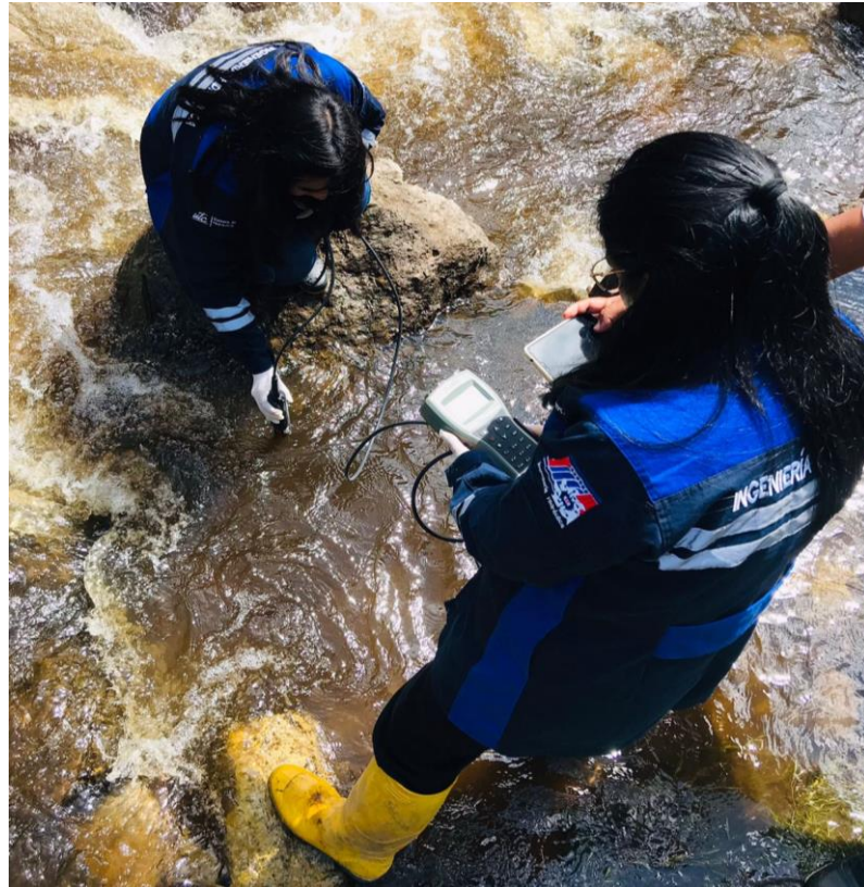
Figura A.4 Toma de muestra cuenca media (Puente California)
