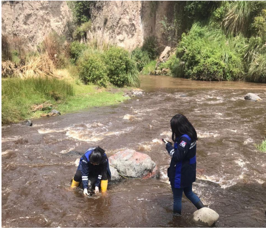
Figura A.8 Toma de datos de la temperatura del agua y Ph (cuenca baja)
