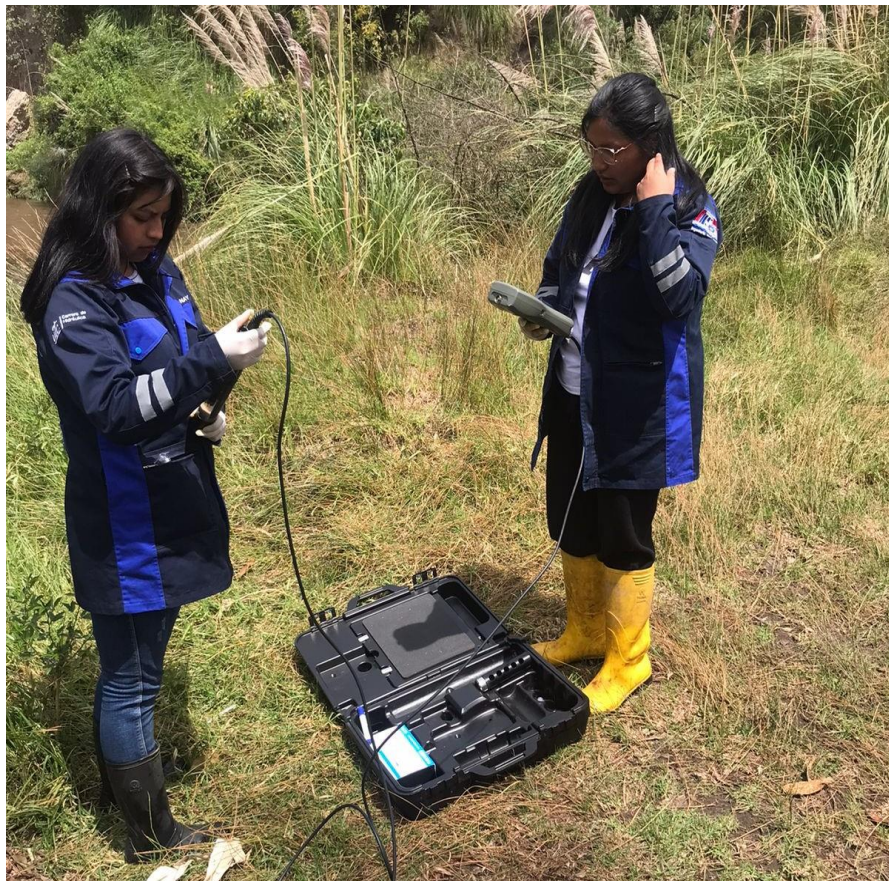
Figura A.8 Toma de datos de la temperatura del agua y Ph (cuenca baja)
