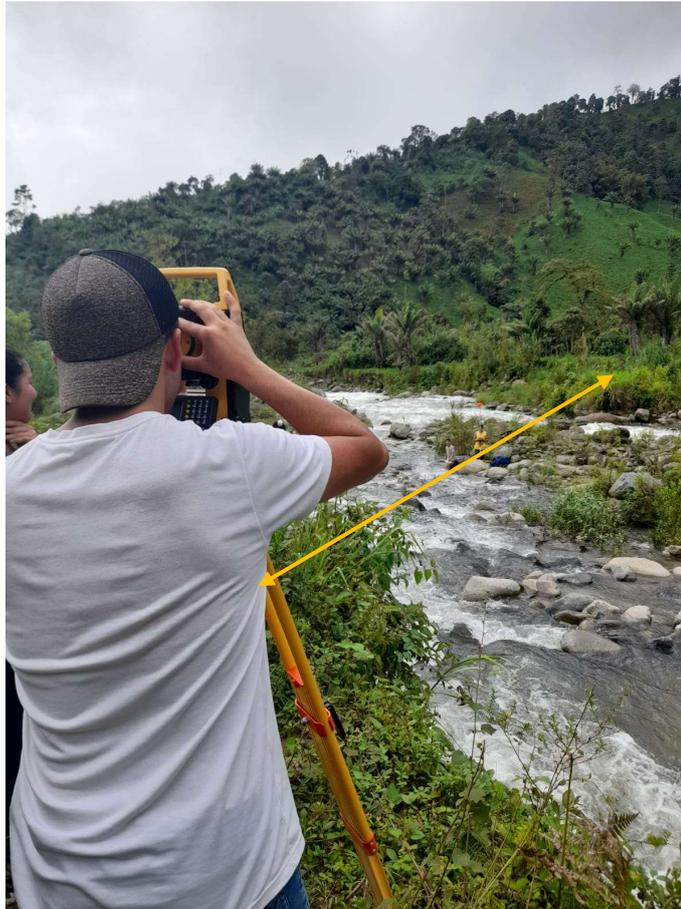
Figura VI.3 Levantamiento batimétrico, sección inicial
