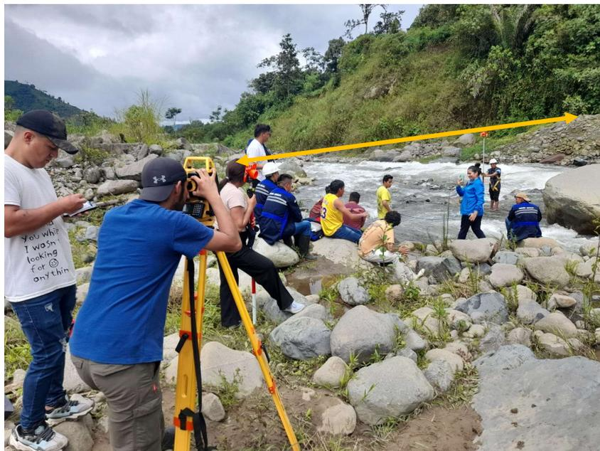
Figura VI.4 Levantamiento batimétrico, sección final
