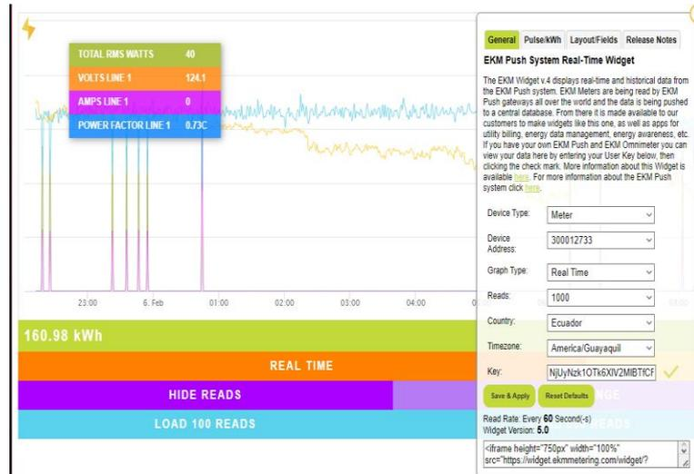
Figura 4.16 Datos de potencia, voltaje, corriente y factor de línea en el sistema EKM.
