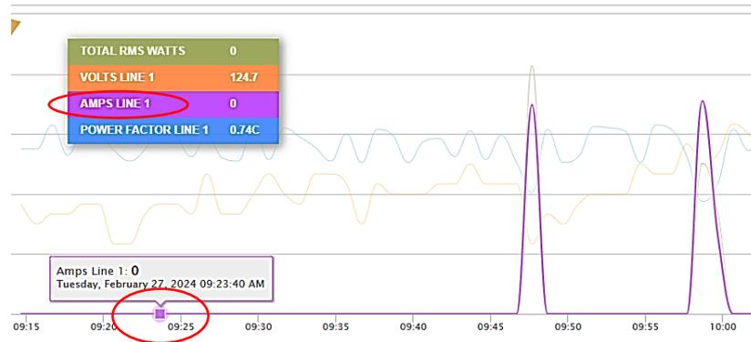
Figura 5.2 Comportamiento de la corriente en la línea 1 del sistema de bombeo.
